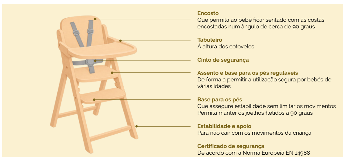
Figura 19 Características da cadeira de refeição para garantir uma postura adequada e segura.
